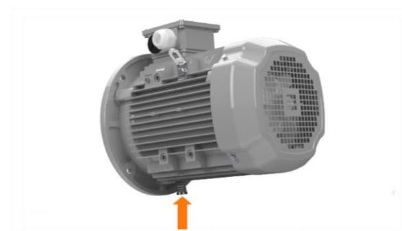
**Abbildung 5:** Kondenswasserbohrung nach Entwässerung mit Loctite abdichten und verschließen
